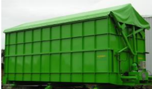
Abbildung 3: Abdeckbarer Schubbodencontainer zur Feststoffeinbringung (Bauphase)
